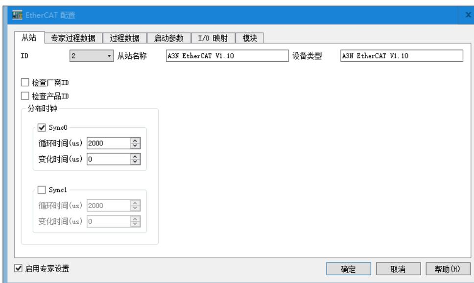
6) 点击“启用专家设置”，右键点击后插入参数 16#6098:0（回原模式），16#6099:1（回原搜索速度），16#6099:2（回原爬行速度）。
