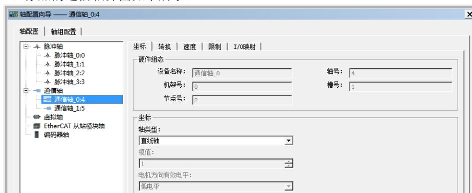
5) 若需要使用驱动器回原(MC\_Home 指令), 需配置回原模式 16#6098:0 以及回原搜索速度 16#6099:1, 回原爬行速度 16#6099:2, 操作如下：
